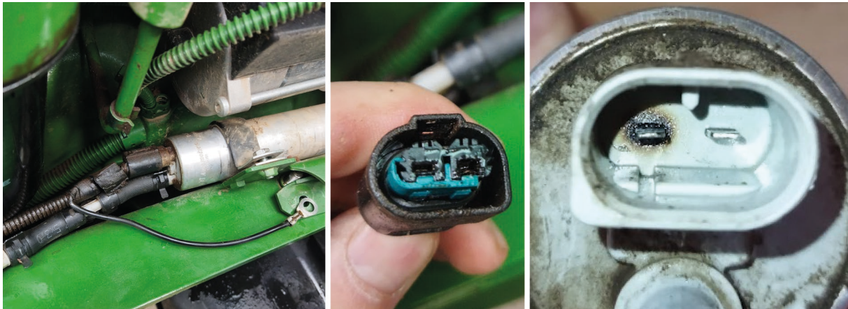
Abbildung 18: Fehlerhafte Steckverbindung für die Stromversorgung der Kraftstoffpumpe
