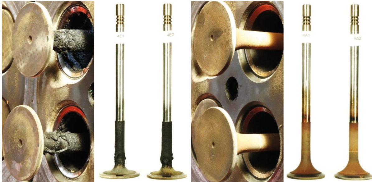
Abbildung 28: Einlassventile (links) und Auslassventile (rechts) des Traktors FE-S bei 2.100 Bh
