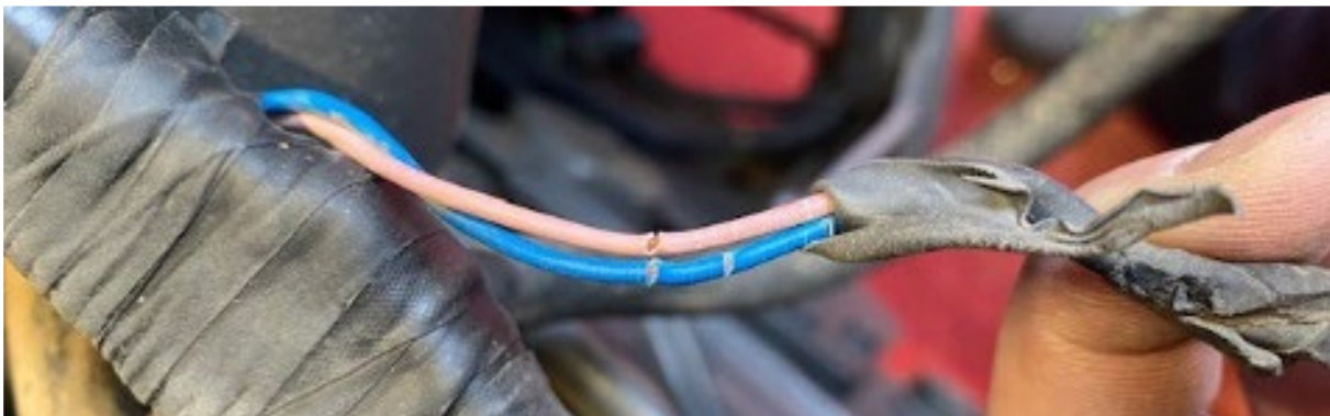
Abbildung 23: Beschädigte Kabelisolierung an der Verkabelung des Kraftstoffsystems am Traktors FE-S
