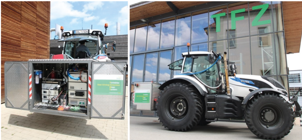
Abbildung 15: Portable Emissionsmessung am Traktor VA-K bei einer Straßenfahrt
