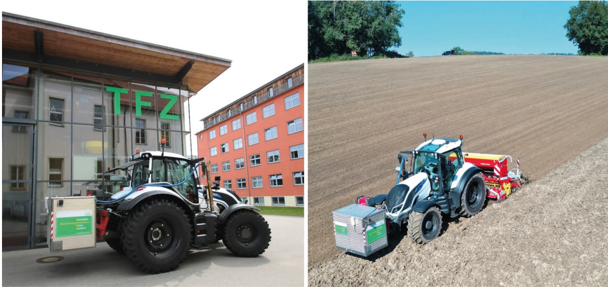
Abbildung 50: Messungen der tatsächlichen Abgasemissionen am Traktor VA-K beim Straßentransport (links) und Säen (rechts)
