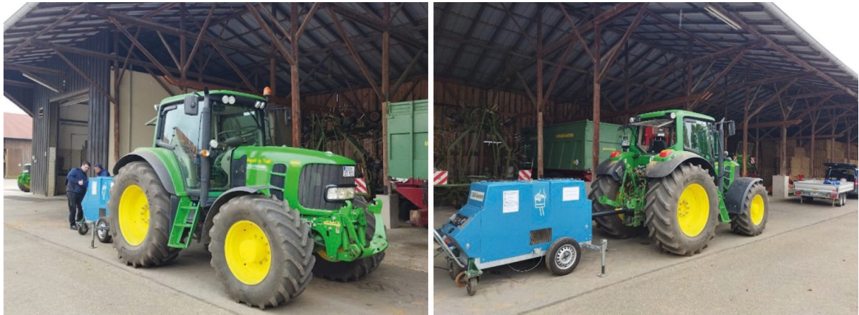
Abbildung 16: Leistungsmessung am John Deere 6930 Premium
