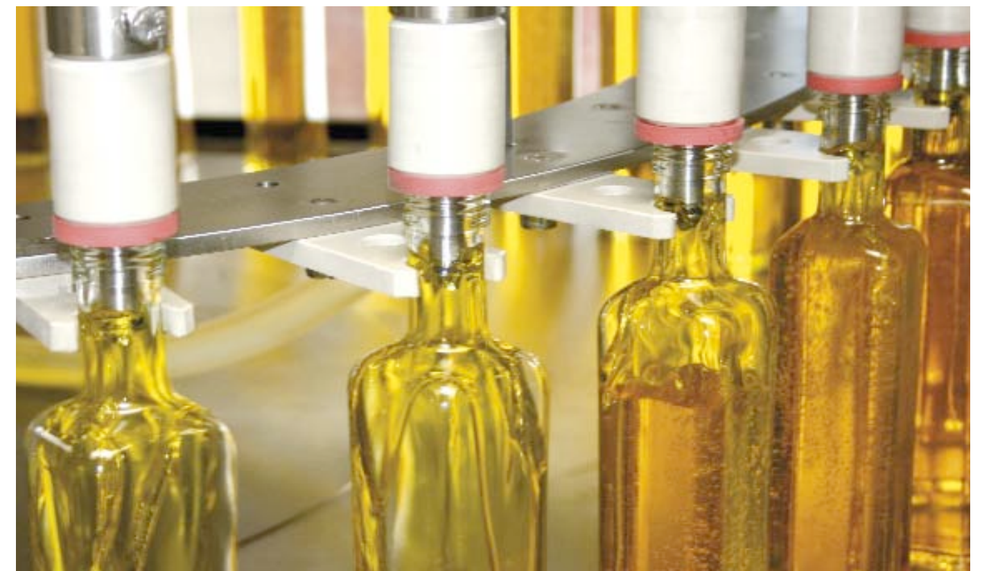
Abfüllung: Nach der Pressung wird das Öl gefiltert und in Flaschen abgefüllt. Abfüllanlage der Teutoburger Ölmühle
