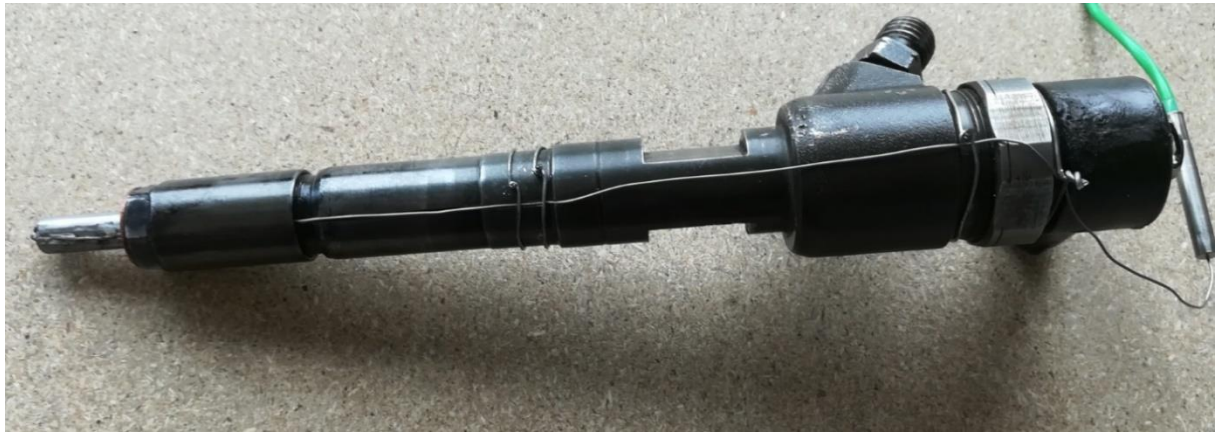
Abbildung 12: Für Temperaturmessung an der Düsen Spitze modifizierte Einspritzdüse
