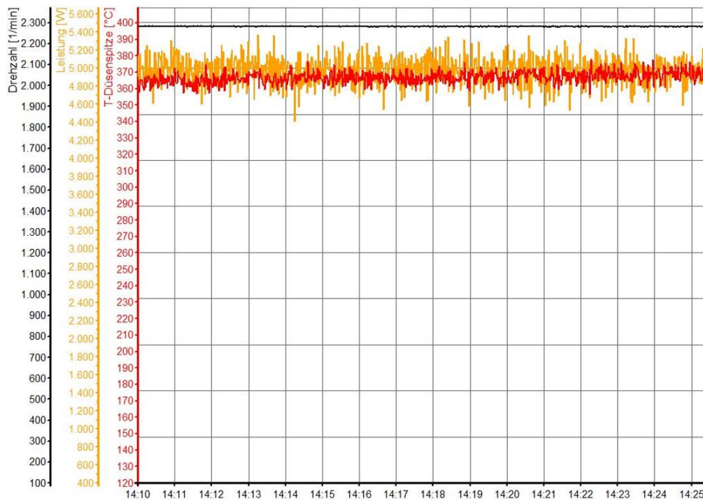
Abbildung 42: Auswertung mit Temperaturmessung ohne direkten Kontakt des Thermoelements
