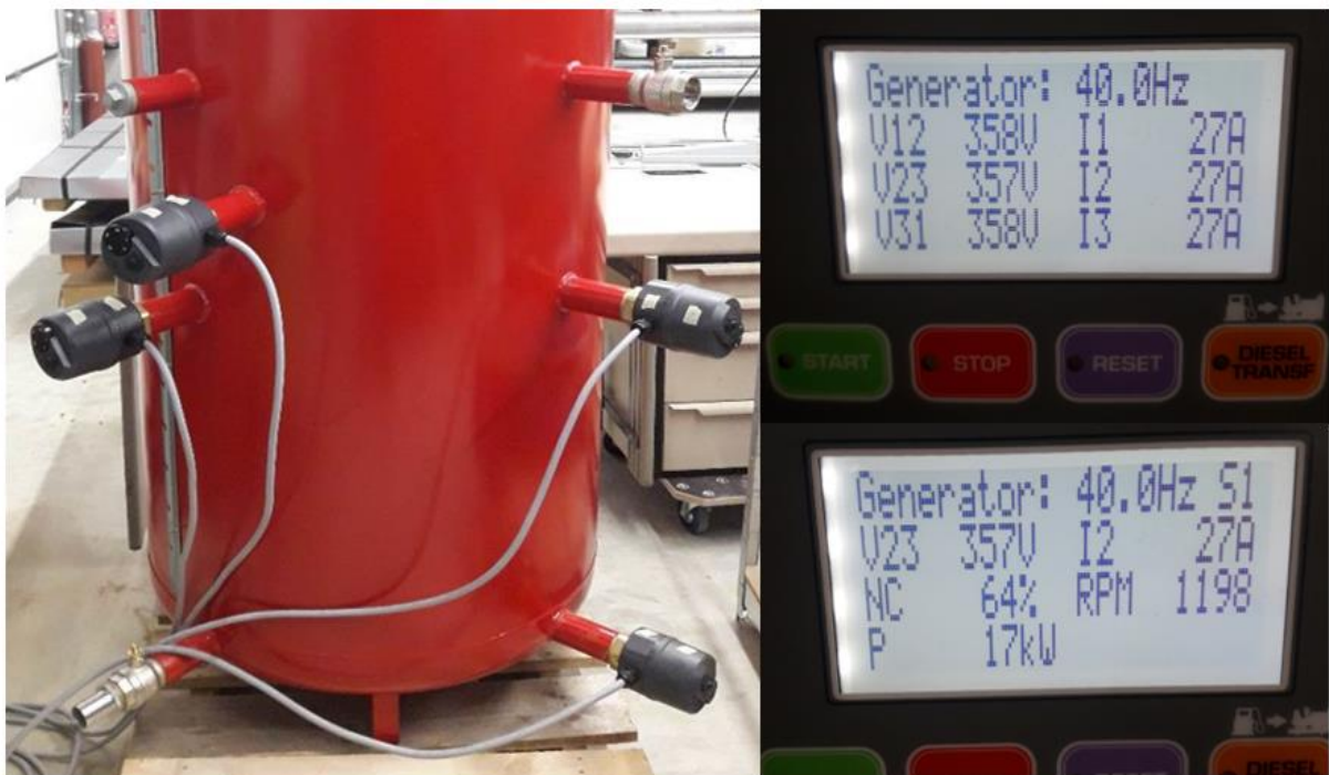
Abbildung 19: Testlauf zur Last- und Drehzahlsteuerung
