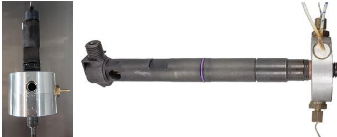
Abbildung 74: links: Anschlussadapter der Firma Leitenberger. Die Düse (unten) ist frei zugänglich und kann in einen Heizblock eingebracht werden, vergleichbar zu dem im Projekt „ENIAK“ eingesetzten Konzept (rechts).
