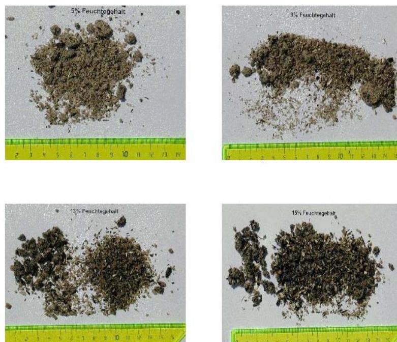
Abb. 5: Mahlverhalten in Abhängigkeit vom Feuchtegehalt, Probe „Öltyp“, Mühle M 85.00
