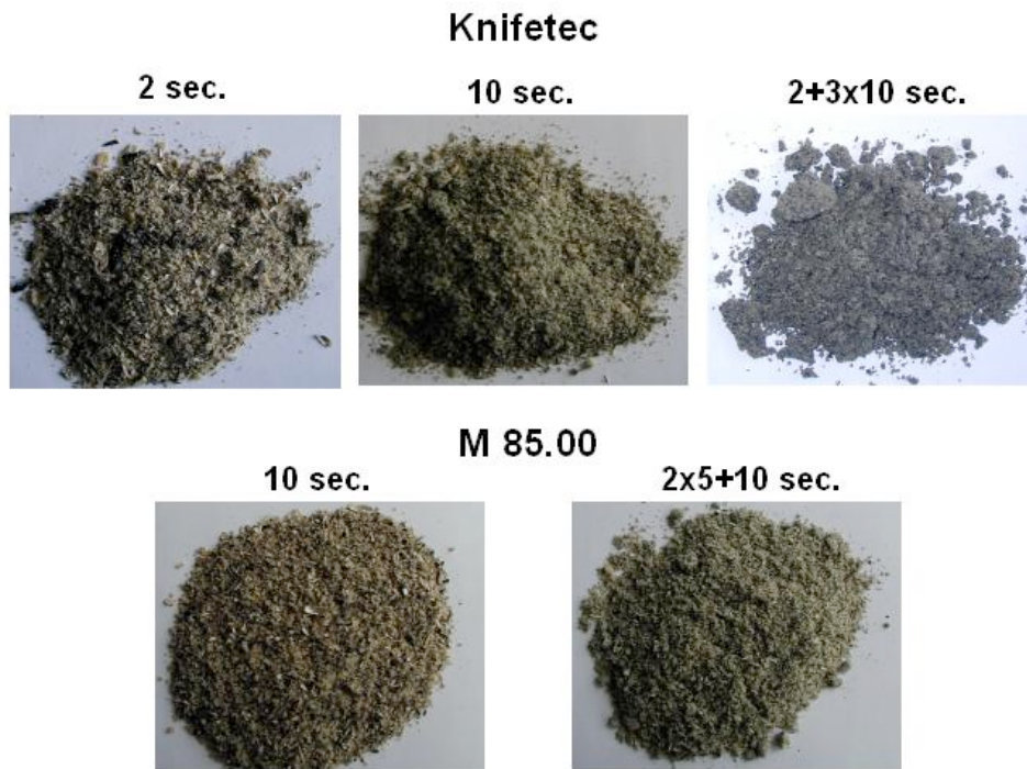
Abb. 2: Mahlverhalten in Abhängigkeit von der Mühle und der Mahldauer, Probenmaterial „Öltypen“
