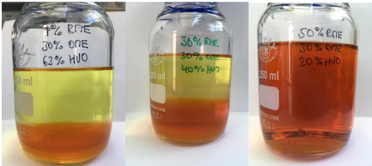
Abb. 9: Bei 110 °C für 120 h mit einer Luftfeuchtigkeit von 15 % gealterte Proben mit RME.
