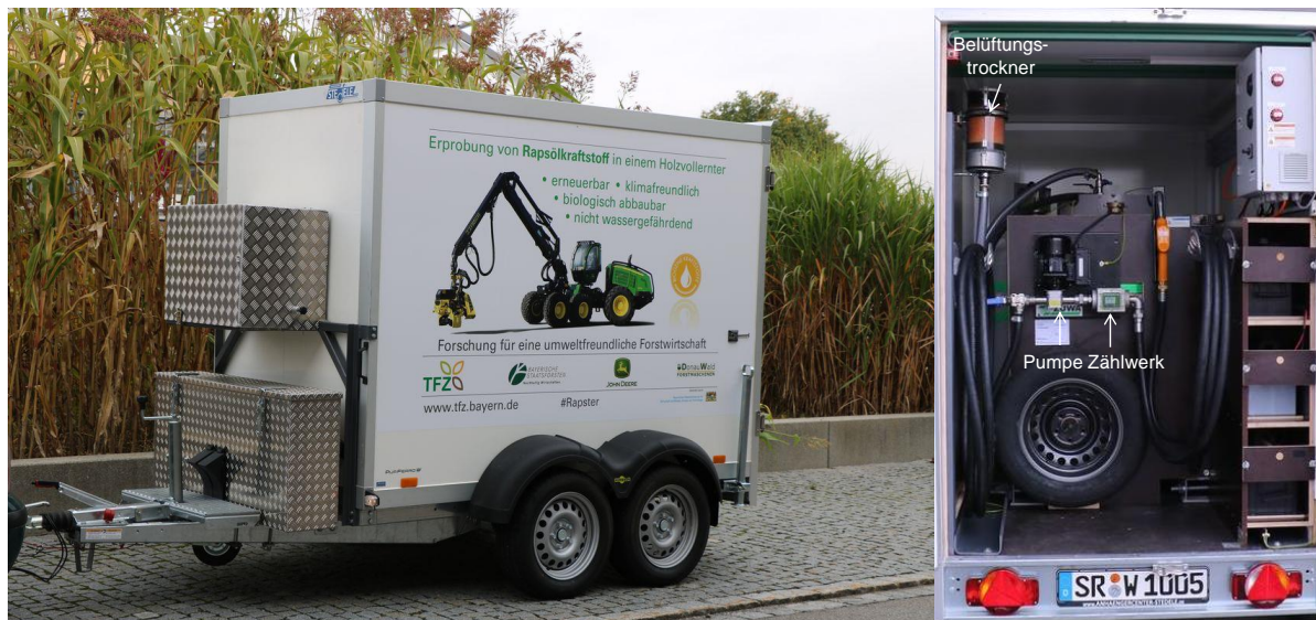
Abbildung 18: Isolierter Kofferranhänger als mobile Tankstelle für Rapsölkraftstoff
