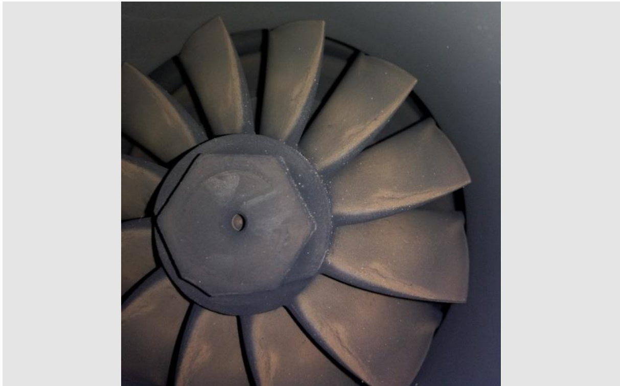
Abbildung 32: Turbolader des Harvestermotors mit üblichen Abnutzungsspuren nach 3.500 h Betrieb
