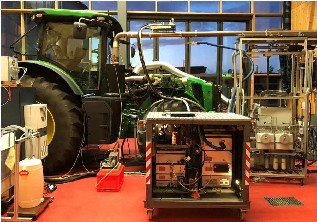
Abbildung 13: Aufbau des John Deere 8370R am Traktorenprüfstand des TFZ
