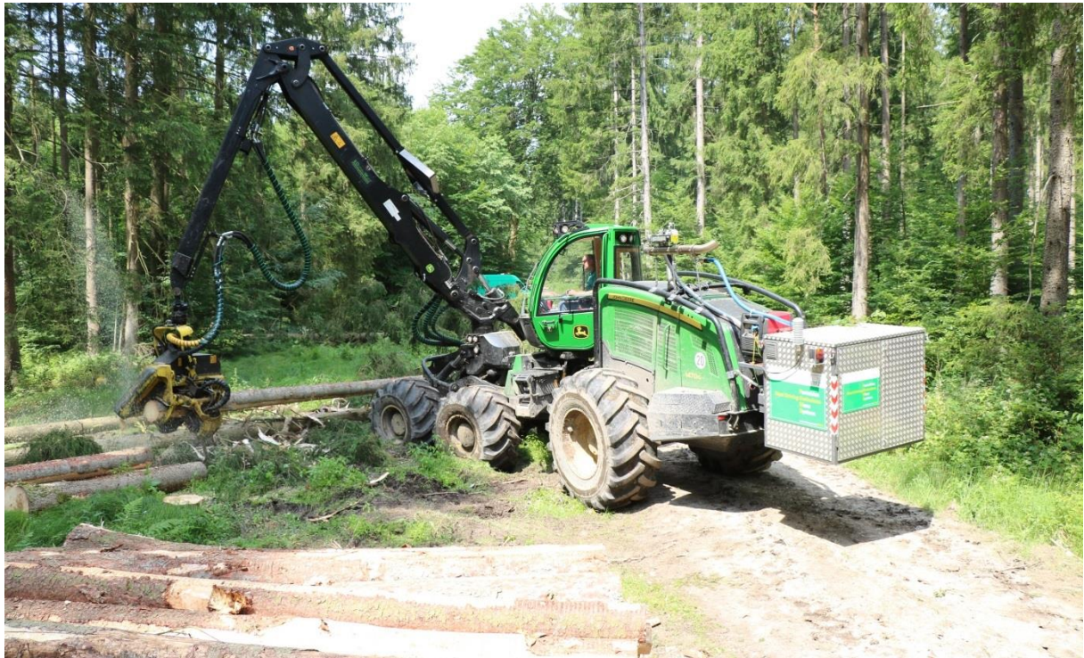
Abbildung 6: PEMS-Aufbau am Heck des Harvesters im Praxiseinsatz
