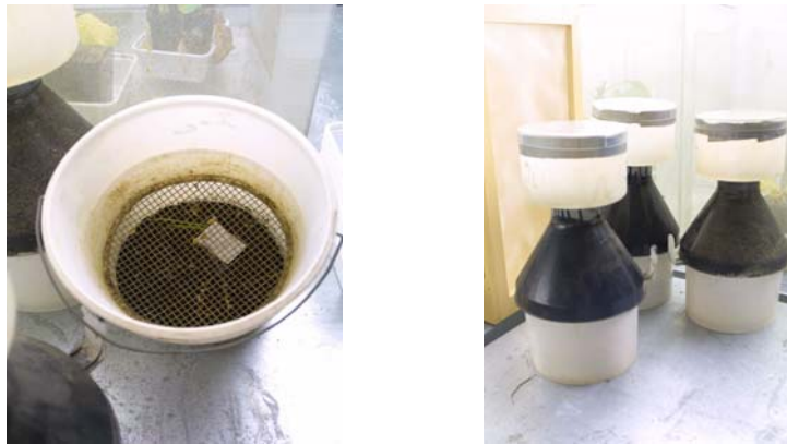
Abb. 2: Eimer mit Drahtgitter und Substrat zur Aufnahme der aus den Schoten fallenden Mückenlarven und entsprechende Eklektoraufsätze für die Eimer zum Fang der geschlüpften, adulten Mücken.
