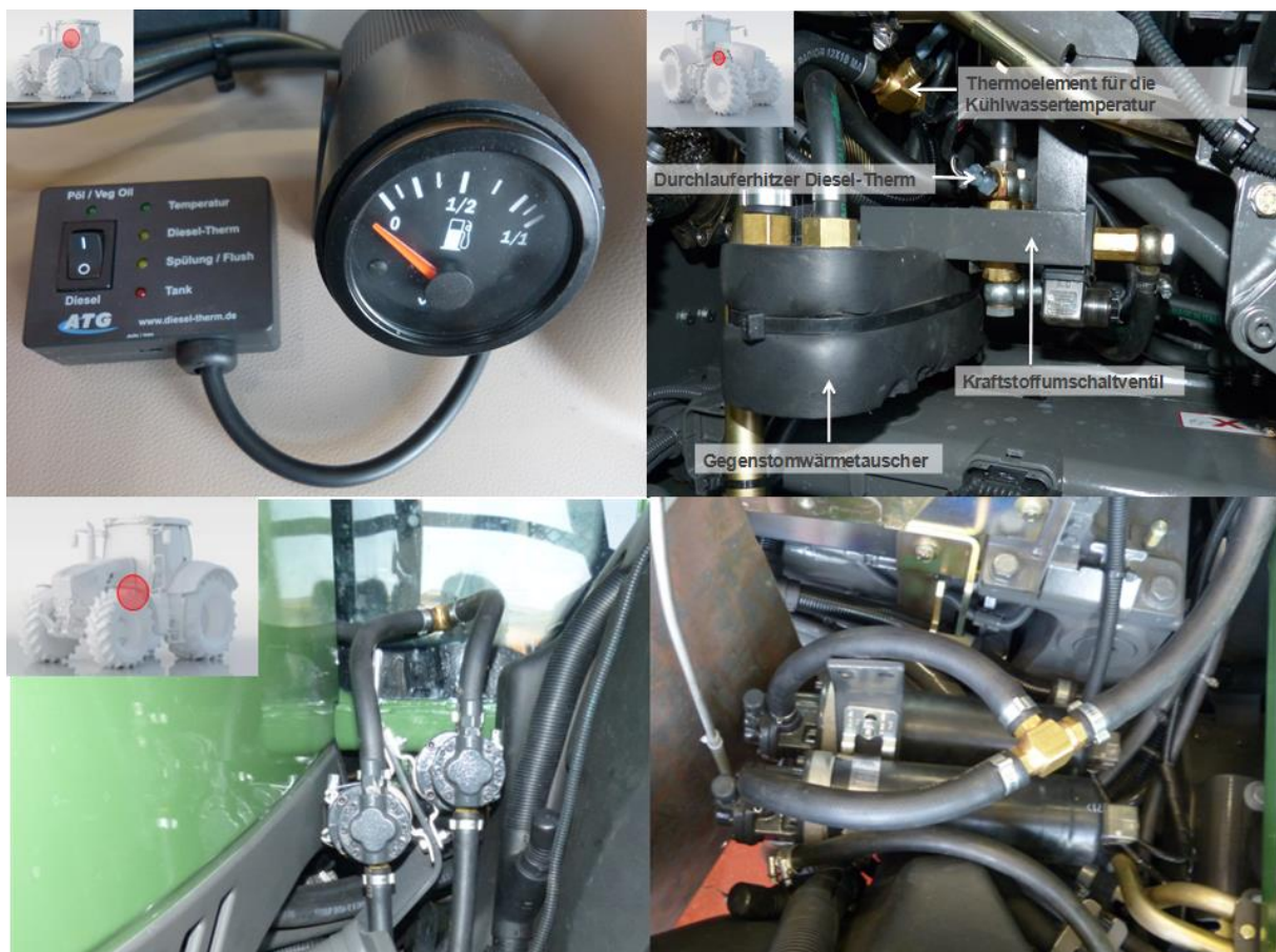
Abbildung 7: Nachgerüsteter Kraftstoffumschalter (links oben) und Füllanzeige für den Dieseltank, zusätzliche Zahnradpumpen für das Pflanzenölkraftstoffsystem (links und rechts unten) sowie Umschalteneinheit inkl. Gegenstromwärmetauscher (rechts oben)
