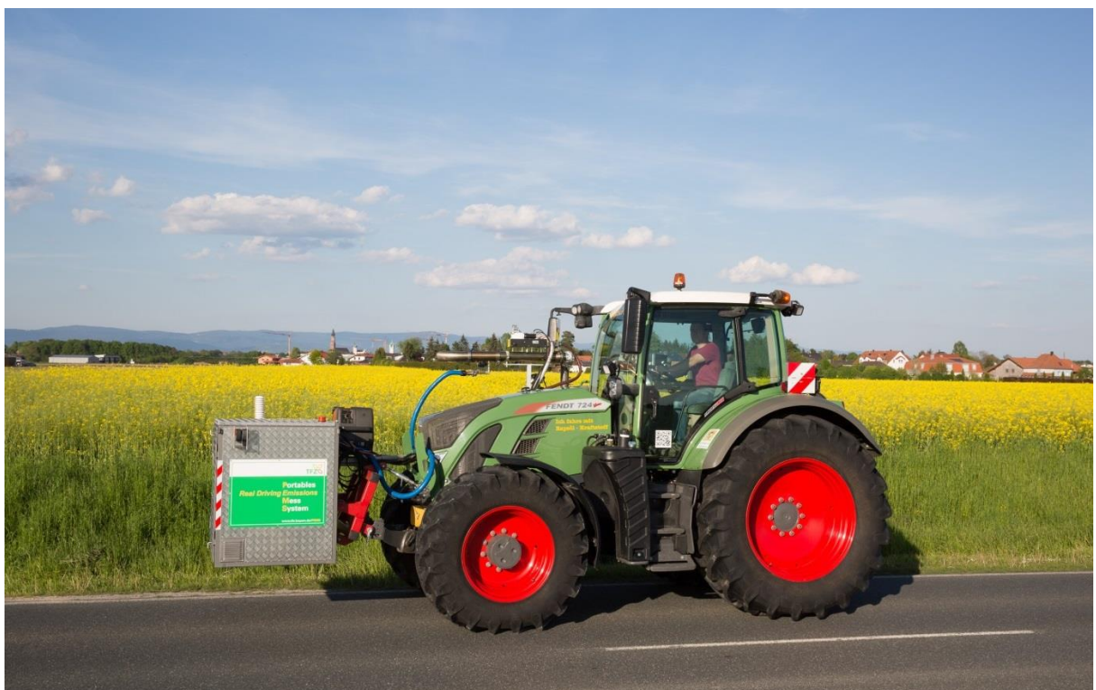
Abbildung 22: Portable Emissionsmessung am Traktor FE-S bei der Straßenfahrt
