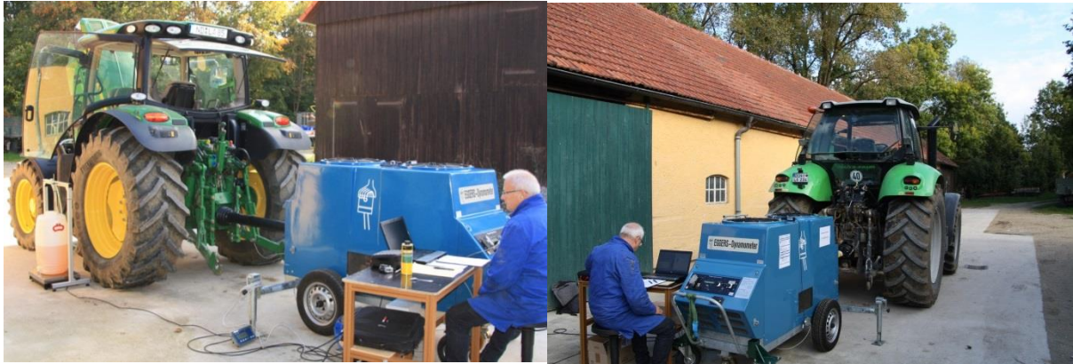
Abbildung 24: Prüfaufbau der Leistungs- und Verbrauchsmessung an den Traktoren JD-N und DE-N an der Versuchsstation Straßmoos
