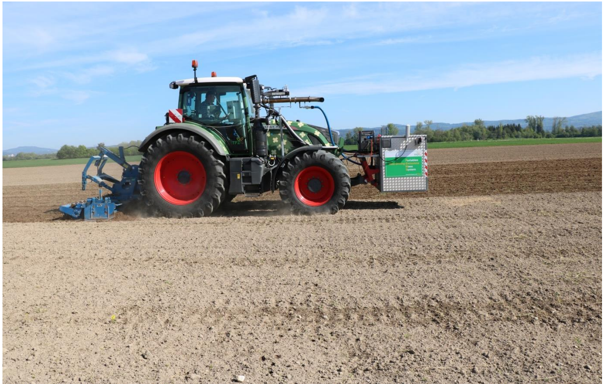
Abbildung 21: Portable Emissionsmessung am Traktor FE-S mit einer Kreiselegge
