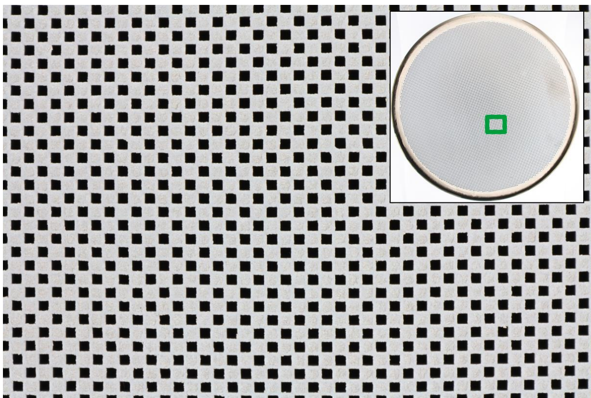
Abbildung 97: Bildausschnitt von der Oberfläche der Einlassseite des Abgaspartikelfilters beim Traktor Fendt Vario 724 S4 (FE-S)
