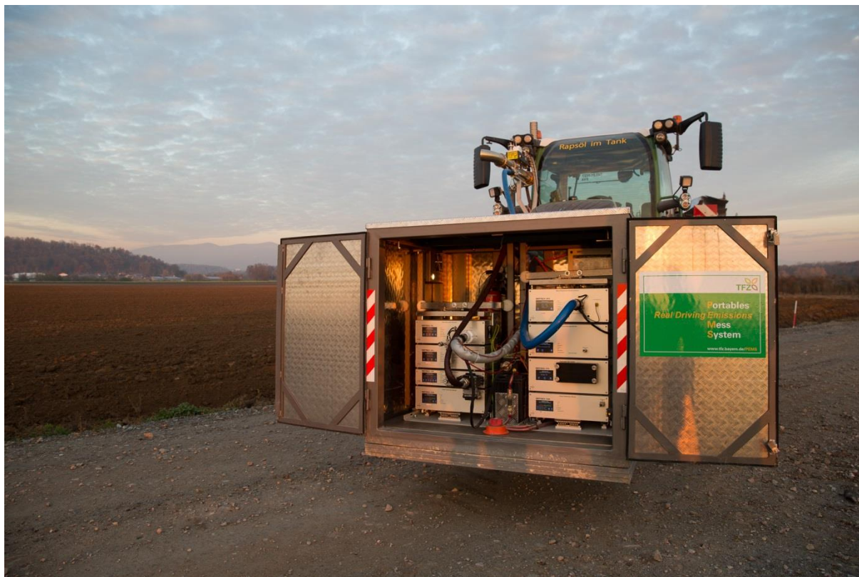
Abbildung 18: Portables Emissionsmesssystem im geöffneten Schutzgehäuse am Frontkraftheber eines Traktors montiert
