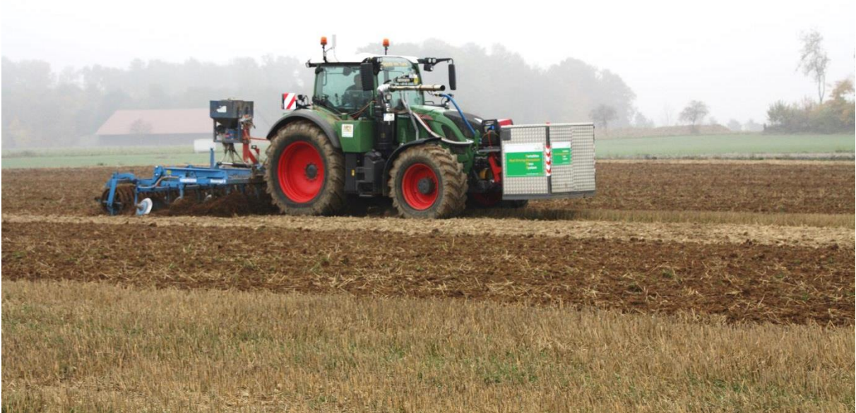
Abbildung 20: Portable Emissionsmessung am Traktor FE-S mit einem Grubber
