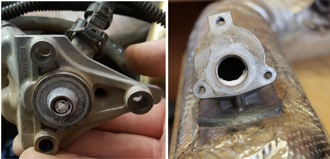
Abbildung 92: Injektor (links) und Injektoraufnahme (rechts) für die Dosierung der Harnstofflösung am Traktor FE-S
