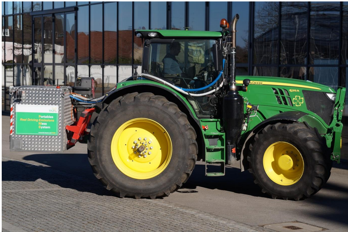
Abbildung 23: Portable Emissionsmessung am Traktor JD-S bei der Straßenfahrt
