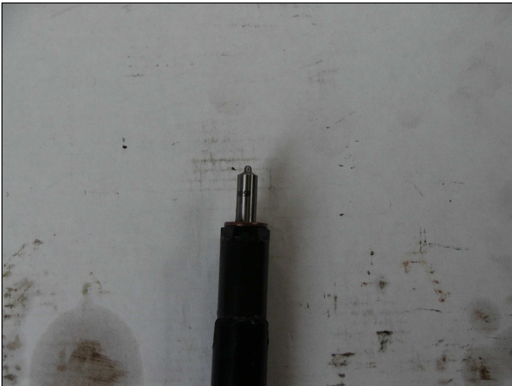
Abb. 13: Gleiche Düse wie Abb. 12, hier nach Instandsetzung.
