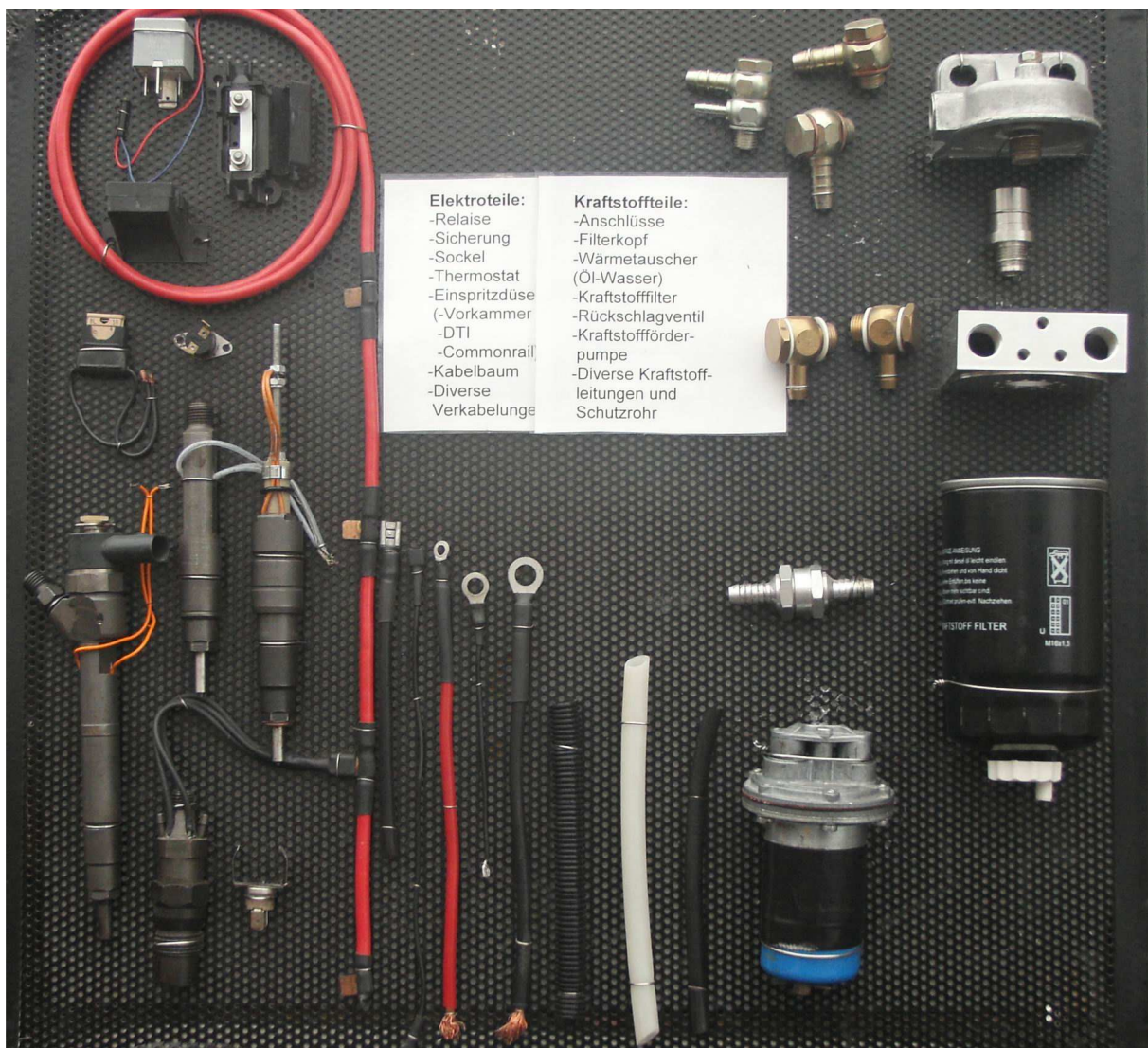
Abb. 6: Bauteile Umrüstung Hausmann
