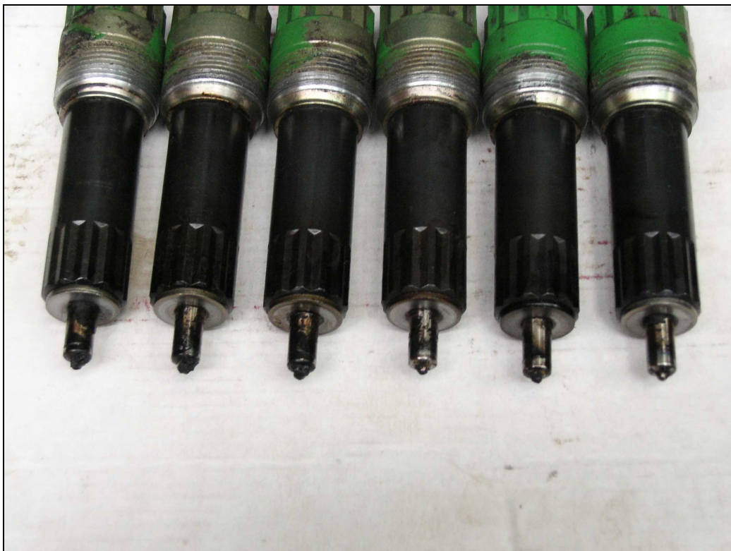
Abb. 3: Düsen aus einem JD8100 (links leichte Verbrennungsrückstände).
