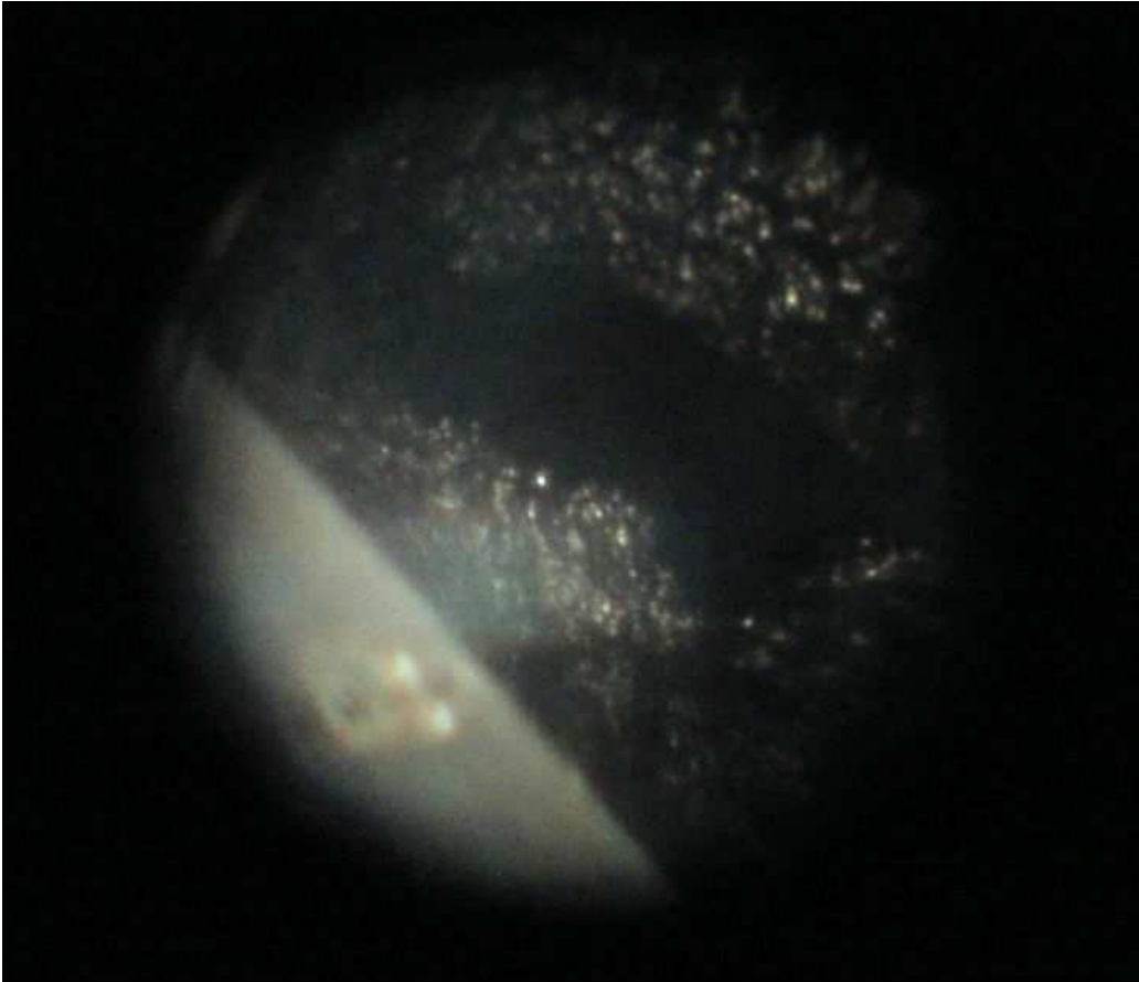
Abb. 2: Beispiel von Verkokungen an einem Ventil ( 10fache Vergrößerung).
