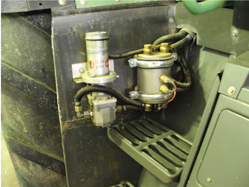
Abb. 4: Umrüstung eines Fendt Traktors mit Beam Plus System. Gut zu erkennen ist der grundsätzliche Aufbau des Systems ( zusätzliche Kraftstoffpumpe, Behälter für die Pflanzenölerwärmung durch Glühkerzen sowie Temperaturfühler)
