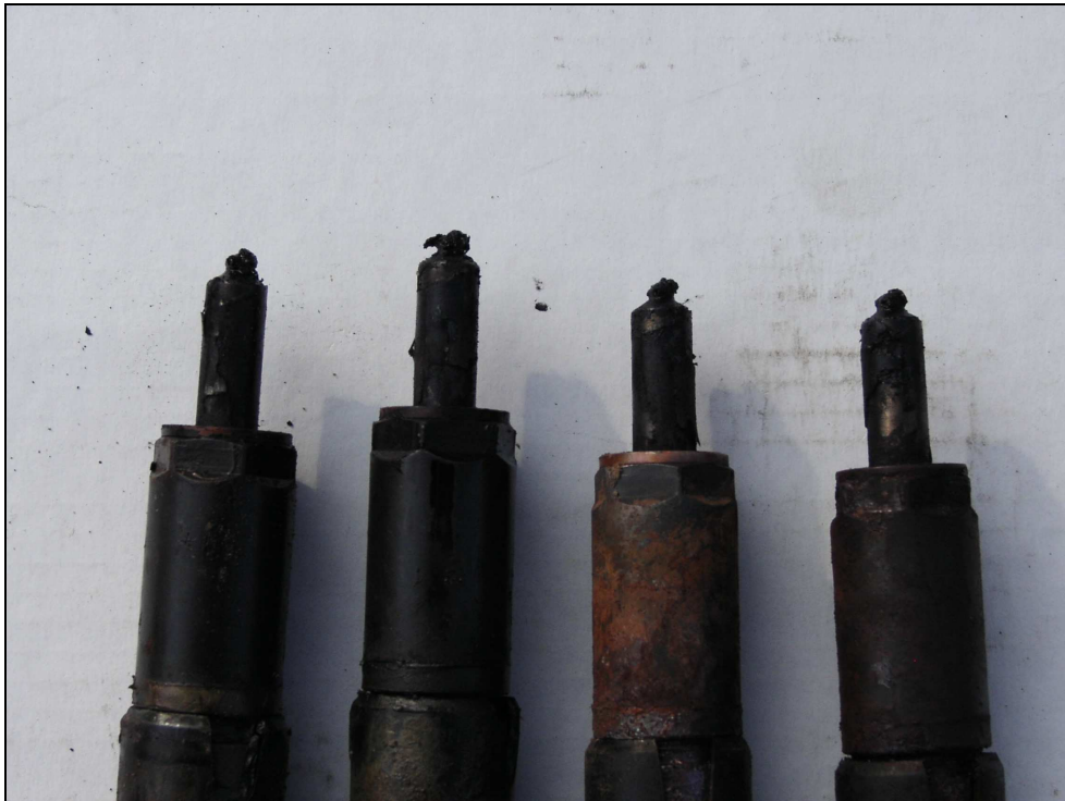
Abb. 12: Fehlerhafte Düsen. ( Öffnungsdruck um ca.25 -30 bar zu niedrig und nicht sauber schließende Düsennadeln. Dadurch auch die Ablagerungen, die dann zum Ablenken des Einspritzstrahles führen.)
