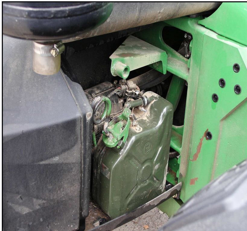
Abb. 7: Beispiel einer Motorvorwärmung an einem JD 7720 hier über eine Standheizung die das Motorkühlwasser erwärmt. Eine weitere Möglichkeit ist die Vorwärmung des Kühlwassers über einen 220V Wechselstromanschluss.
