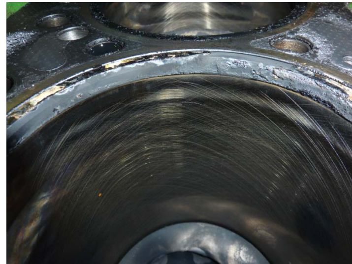
Bild 8 bis 11: Zylinder 2, Einspritzstrahlbilder auf Kolbenboden, Laufbuchse mit Honung und Feuersteg
