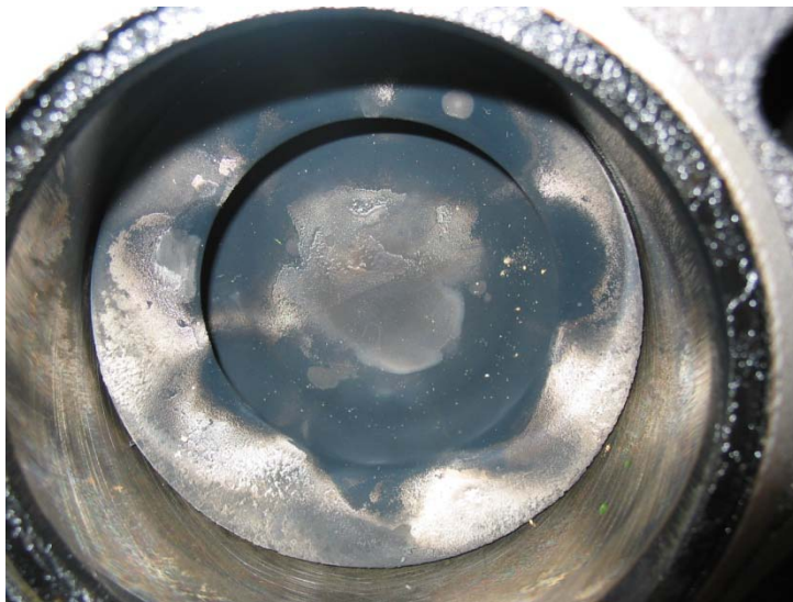
Bild 12 bis 15: Zylinder 3, Einspritzstrahlbilder auf Kolbenboden, Laufbuchse mit Honung und Feuersteg
