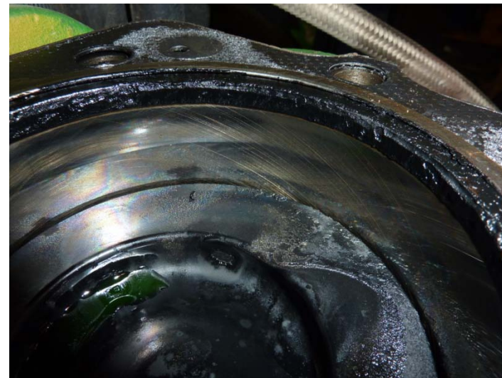
Bild 24 bis 27: Zylinder 6, Einspritzstrahlbilder auf Kolbenboden, Laufbuchse mit Honung und Feuersteg
