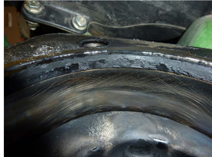
Bild 4 bis 7: Zylinder 1, Einspritzstrahlbilder auf Kolbenboden, Laufbuchse mit Honung und Feuersteg
