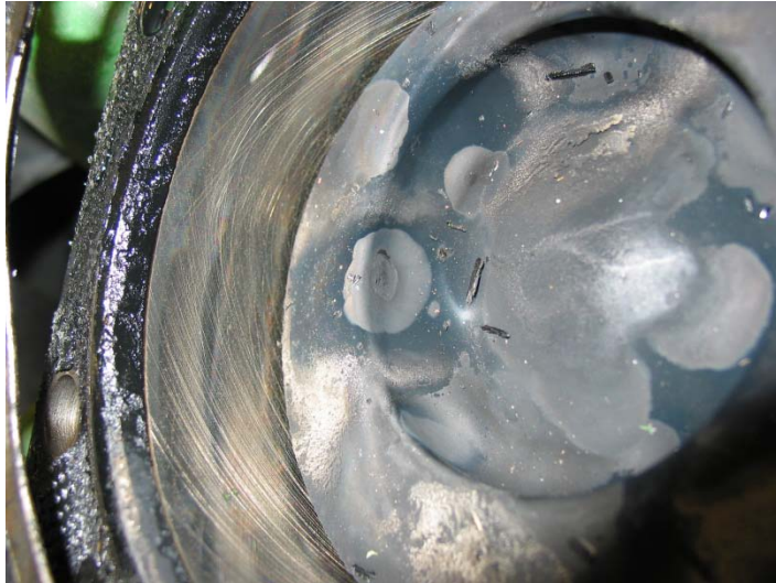
Bild 4 bis 7: Zylinder 1, Einspritzstrahlbilder auf Kolbenboden, Laufbuchse mit Honung und Feuersteg
