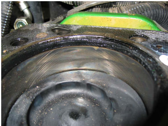
Bild 24 bis 27: Zylinder 6, Einspritzstrahlbilder auf Kolbenboden, Laufbuchse mit Honung und Feuersteg
