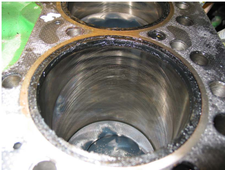
Bild 20 bis 23: Zylinder 5, Einspritzstrahlbilder auf Kolbenboden, Laufbuchse mit Honung und Feuersteg
