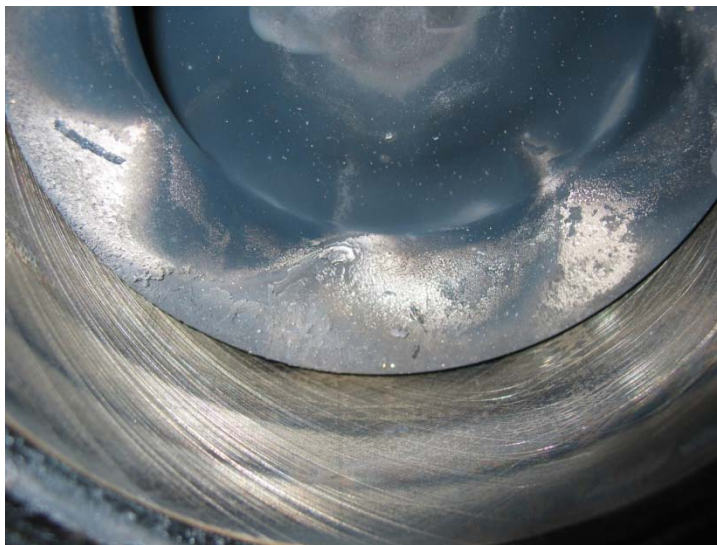
Bild 16 bis 19: Zylinder 4, Einspritzstrahlbilder auf Kolbenboden, Laufbuchse mit Honung und Feuersteg
