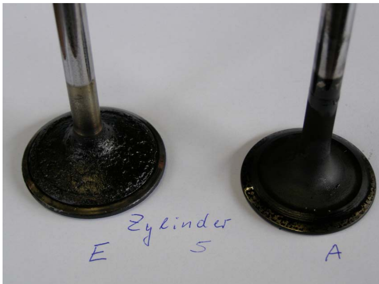
Bild 44 bis 45: Einlass- und Auslassventil und Ventilteller Zylinder 5
