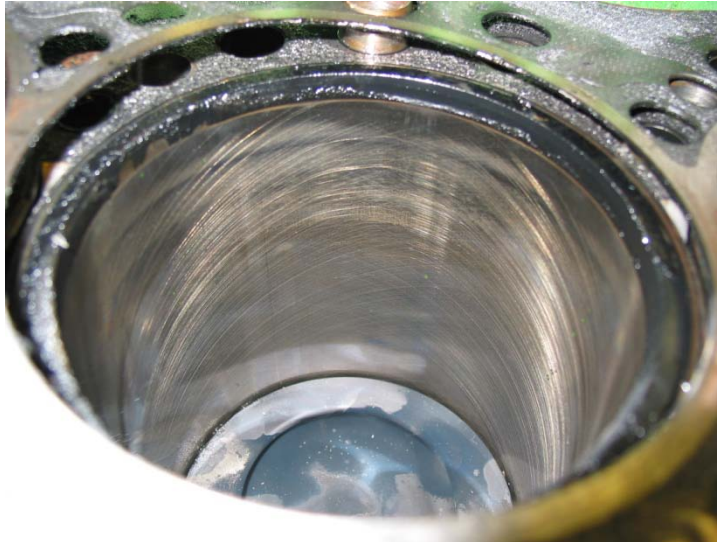
Bild 8 bis 11: Zylinder 2, Einspritzstrahlbilder auf Kolbenboden, Laufbuchse mit Honung und Feuersteg
