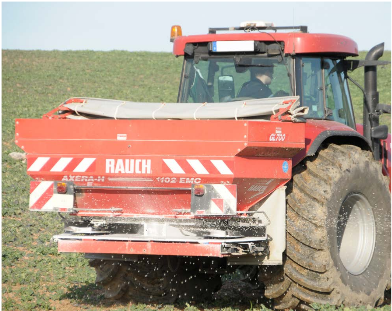
Moderne Schleuderstreuer sind in der Lage, gekörnte Stickstoffdünger präzise auszubringen.
