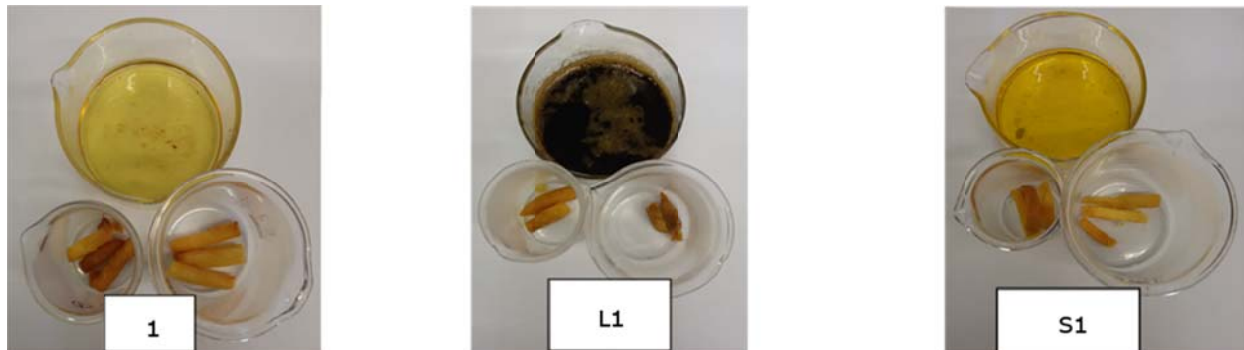
Abbildung 7: Zum Frittieren eingesetztes natives, kaltgepresstes Rapsöl (Probe 1) mit erhöhten Glucosinolatgehalten mit Frittiergut. 1: Frittiertes Rapsöl ohne Zusatz. L1: Frittiertes Rapsöl mit Lecithinzugabe (5%). S1: Frittiertes Rapsöl mit Sinapinzugabe (1%)
