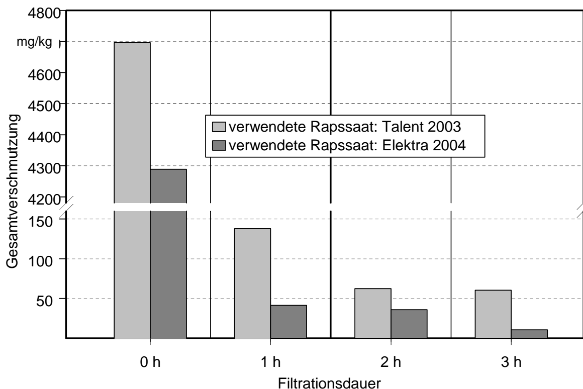
Abbildung 41: Gesamtverschmutzung des Öls nach DIN EN 12662 unter Verwendung einer Kammerfilterpresse in Abhängigkeit von Filtrationsdauer und verwendeter Rapssaat
