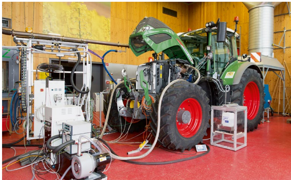
BILD 1 Messungen am Traktorenprüfstand Fendt 724 S4 (© TFZ)
