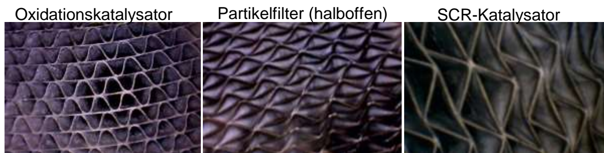
Abbildung 87: Komponenten der Prototyp-Abgasnachbehandlung am Traktor JD-G
