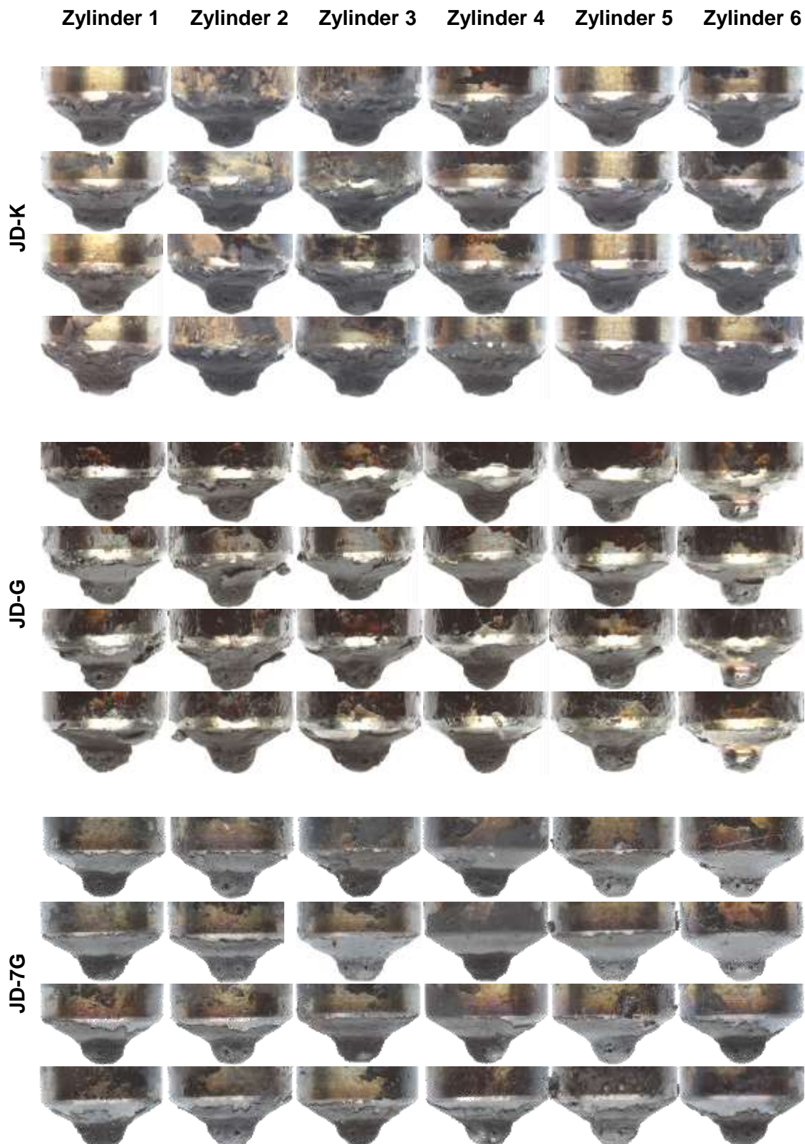
Abbildung 83: Injektorspitzen der Traktoren JD-K, JD-G und JD7-G bei einer Ansicht von vier Seiten (0°, 90°, 180° und 270°)
