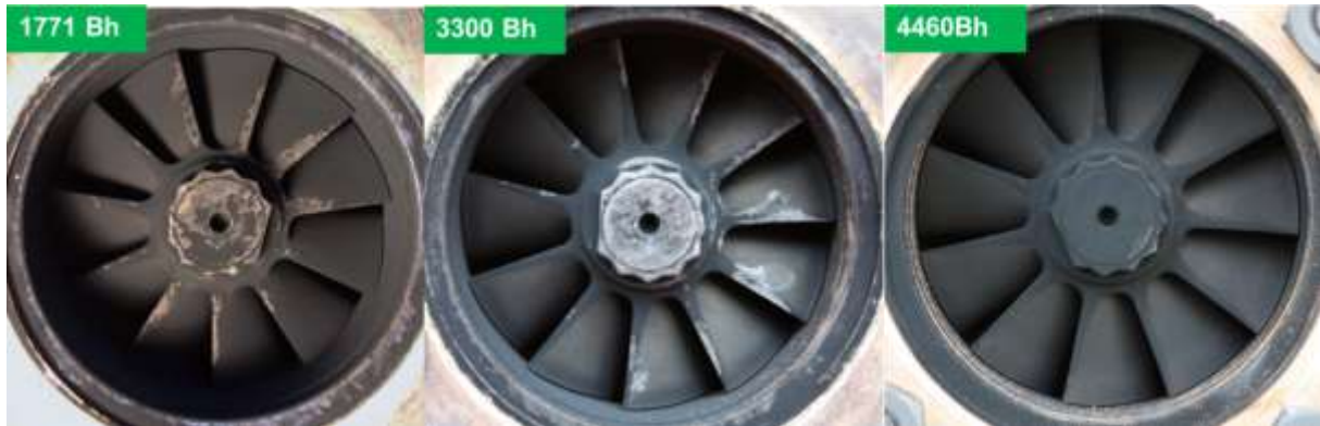
Abbildung 74: Turbinenrad des Abgasturboladers am Traktor DE-K bei 1.771, 3.300 und 4.460 Betriebsstunden (v. l. n. r.)
