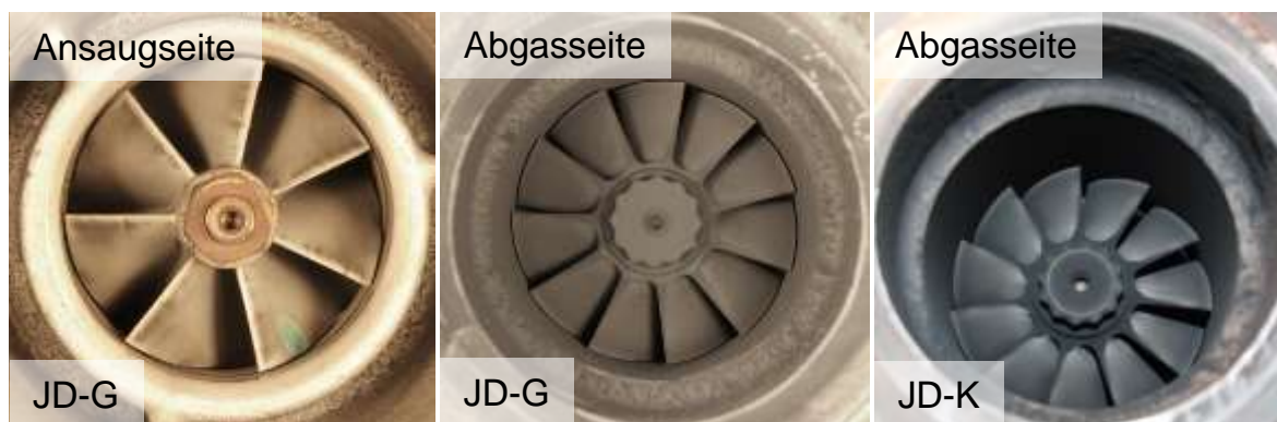
Abbildung 82: Abgas- und Ansaugseite des Turboladers am Traktor JD-G und Abgasseite des Traktors JD-K
