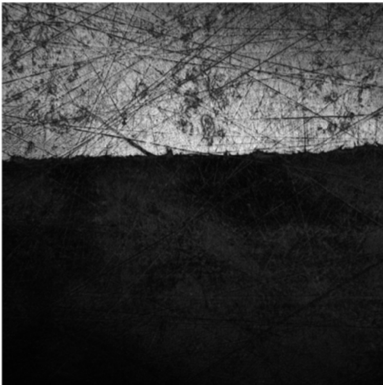
Abbildung 6-63: Mit n-Heptan gereinigte Oberfläche des Steuerventils
