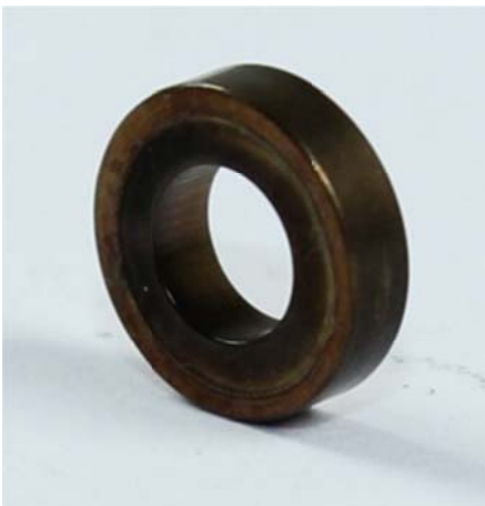
Abbildung 6-10: Bauteil aus dem Injektor zur Belagsanalyse – Abstandsring
