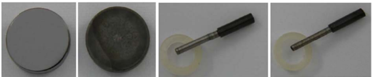
Abbildung 6-38: Prüfkörper vor und nach der Alterung
