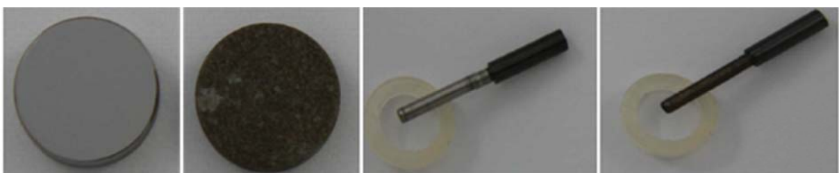
Abbildung 6-21: Prüfkörper vor und nach der Alterung
