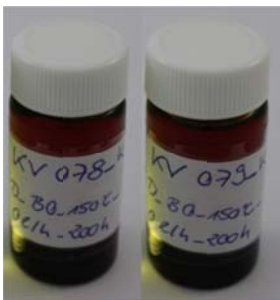
Abbildung 6-20: Mit Prüfplättchen gealterter B0 (links) und mit Ventilstangen gealterter B0 (rechts)
