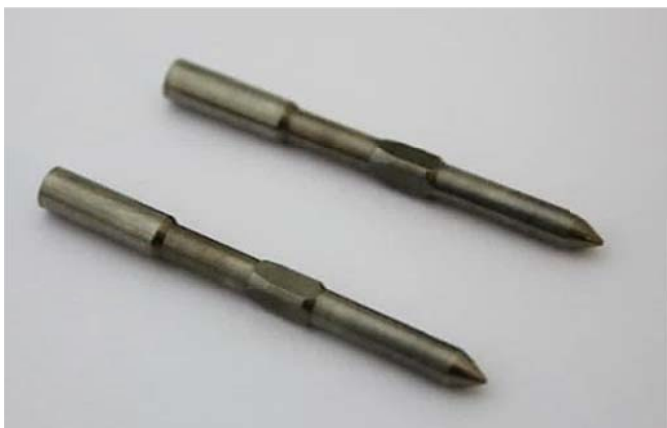
Abbildung 6-57: In B0 eingelagerte Düsenadeln im nicht kraftstoffdurchströmten Rail nach 300 h Betriebszeit ohne sichtliche Belagsbildung
