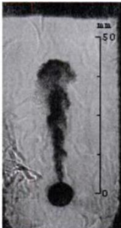
Abbildung 41: Kammeruntersuchungen zum Einfluss der Kraftstoffzusammensetzung auf Zerstäubung und Verdampfung; Aufnahme des Einspritzstrahls 1 ms nach Einspritzbeginn (nach Tschöke, 2009)
