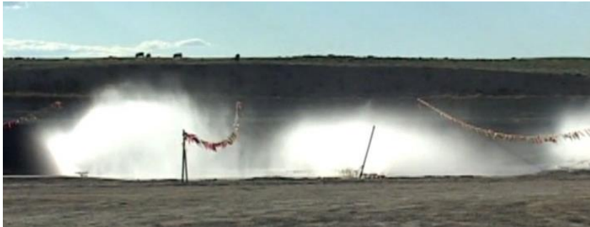
Abbildung 26: Verdampfung der rückgespülten Fracking-Flüssigkeit in die Luft [Clark 2013]
