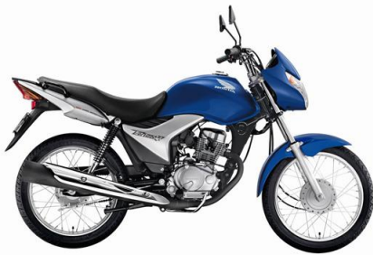
Abbildung 5: "Flex Fuel"-Motorrad, Modell CG150 TITAN MIX [Honda 2009]
