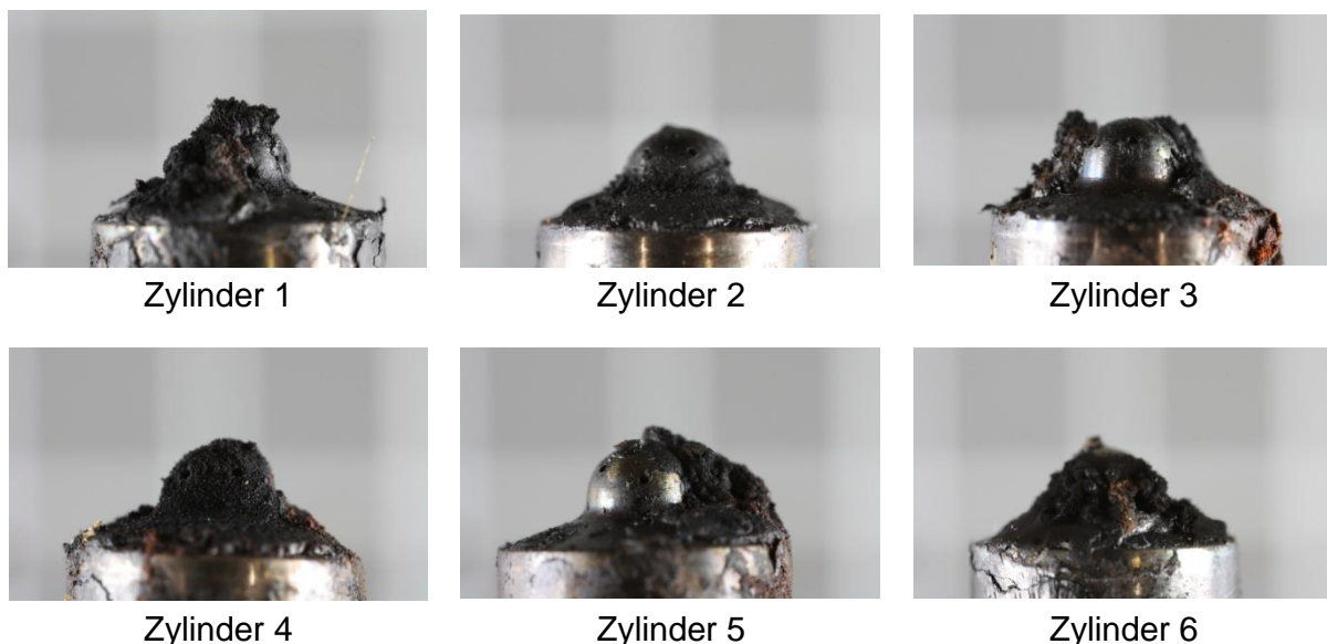
Abbildung 24: Einspritzdüsen des Deutz-Fahr Agrotion TTV 1160 nach ca. 2500 Bh im Feldeinsatz
