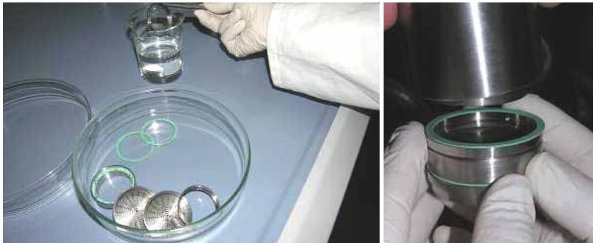
Abbildung 6: Waschung der Filterhalter mit Dichlormethan (links) und Entfernung des beladenen Filterhalters aus der Partikelprobenahmeverrichtung (rechts)
