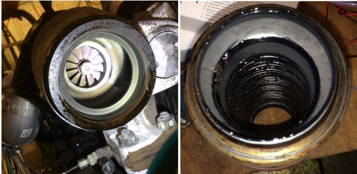
Abbildung 86: Unverbrannter Rapsölkraftstoff nach Motorstart an Turbolader (links) und Abgasflexrohr (rechts)
