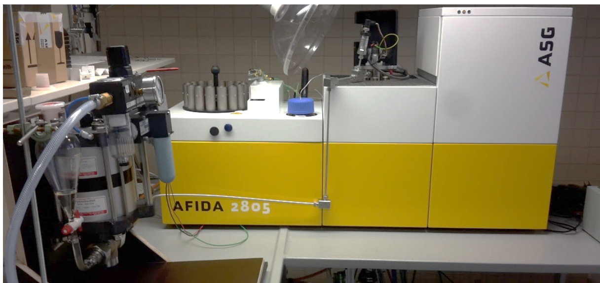
Abbildung 12: AFIDA mit externer Kraftstoffhochdruckpumpe (links) und implementiertem Injektor
